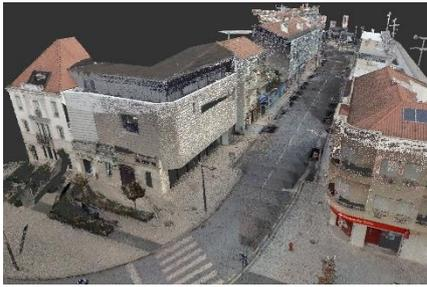
Apresenta-se na globalidade a temática da utilização do varrimento laser tridimensional, já que quando aliada à modelação 3D, permite uma melhor compreensão da nossa área de intervenção.
